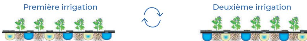
Figure 1. Dispositif expérimental d'un système d'irrigation par assèchement partiel des racines de la pomme de terre.
